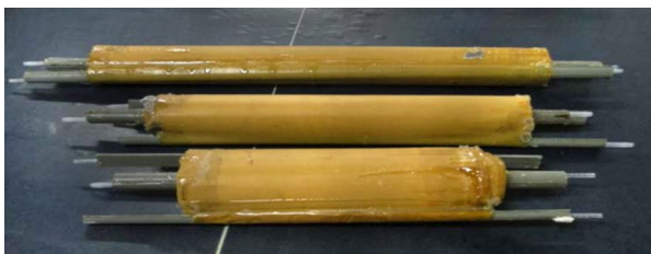
图1 不同尺寸的卷式扩散膜组件
