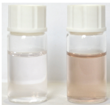
图 2 \text{Mn}(\text{NO}_3)_2 溶液(左)同 \text{NaBiO}_3 反应后溶液(右)
