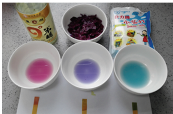
图7 紫甘蓝中花青素的提取及变色实验
