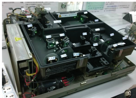
图 4 用激光笔做光源展示双光束紫外可见分光光度计的光路
