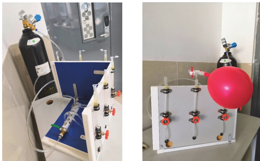
图 1 简易多路气体分流装置
