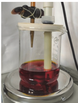
图 1 Na_2S_2O_3 溶液标定实验装置图
