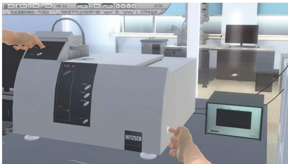
图 2 虚拟仿真实验中热重分析的操作画面
