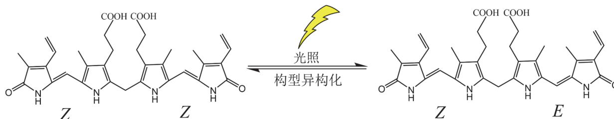
图2 (4Z,15Z)构型胆红素通过光构型异构化转变为(4Z,15E)构型胆红素
