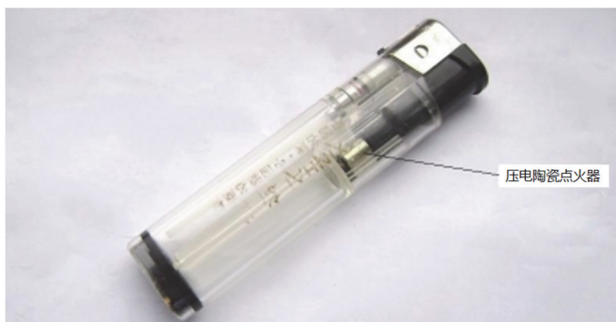
图8 压电打火机及其原理图
