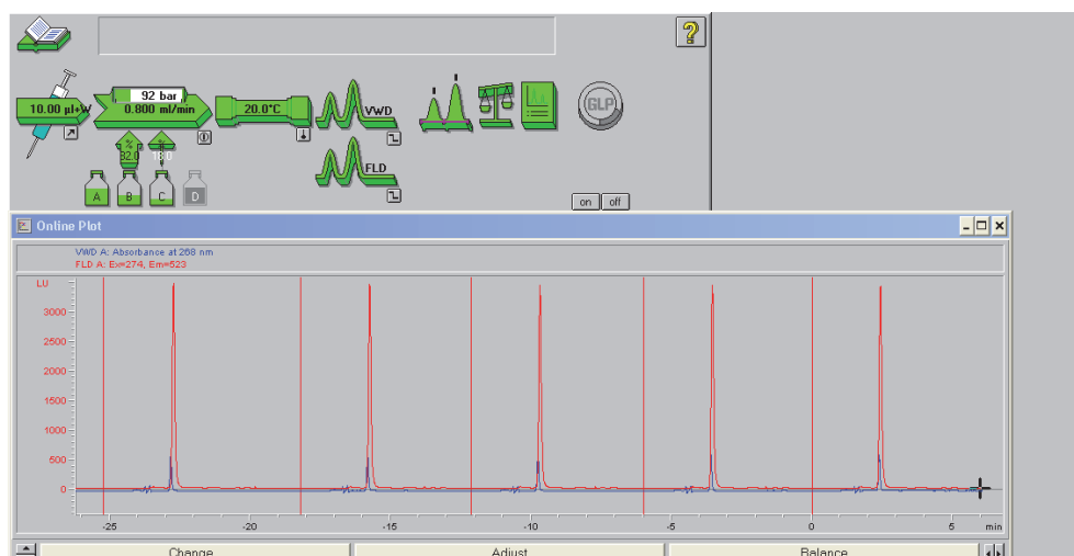
图4 五次重复进样的色谱图
