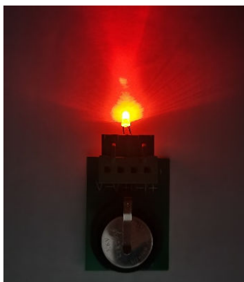
图9 Zn-MnO 2 电池的实际应用测试
