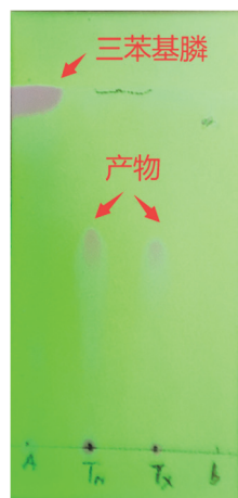
图2 反应15 min时的薄层色谱图
